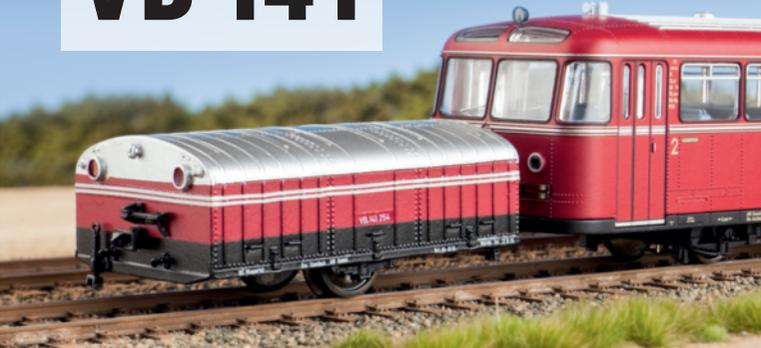
Die Deutsche Bundesbahn beschaffte zu den VT 95, den Vorserien-VT 98 und den Diesel-Aussichtstriebwagen einachsige Gepäckanhänger der Baureihe VB 141; sie besaßen entweder Vorrichtungen zur Fahrrad- oder zur Skimitnahme.
